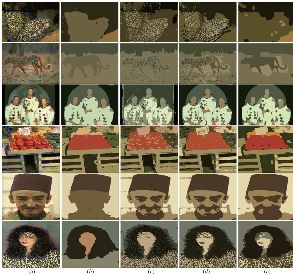
图7 与多区域分割方法对比: (a)本文算法得到的分割轮廓. (b)本文算法得到的均值标签; (c) GMM-EM; (d)SVGMM; (e)KGC.
